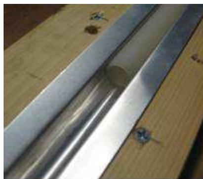
Un espace d'air existe sous le clip. Il permet de réduire les pertes de chaleur par conduction vers le bas. Les pertes par radiation sont également réduites puisque l'émissivité de la surface inférieure du clip est basse.
