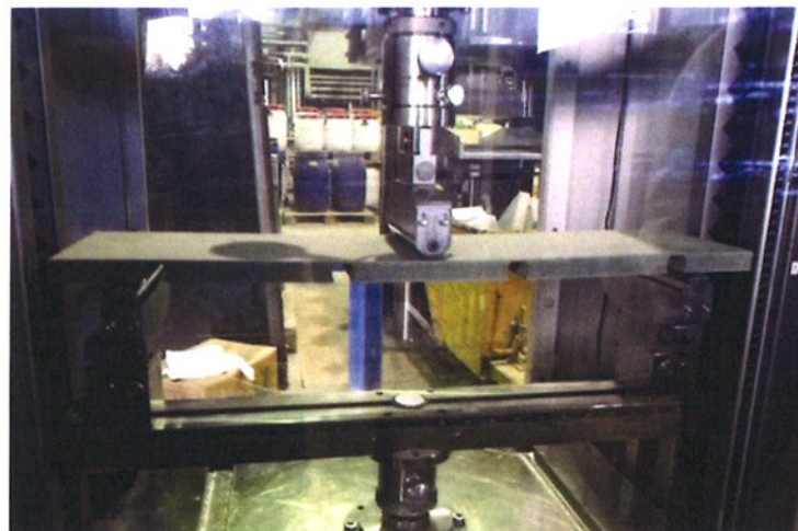
Figure 8 - Illustration d'un essai de flexion 3 points
